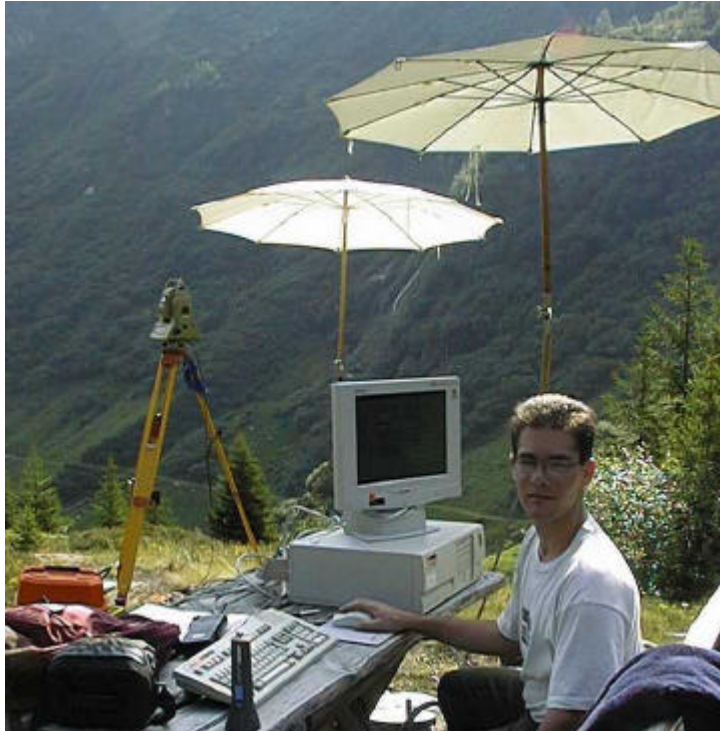
Abbildung 4: Ansteuerung des Tachymeters mittels Computer
