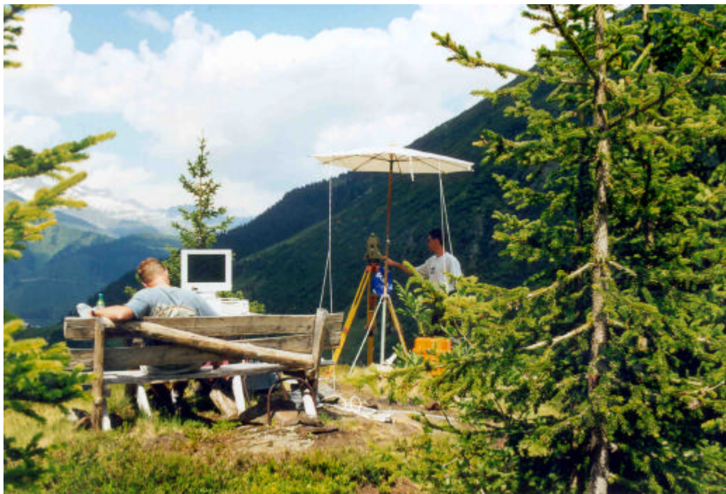
Standpunkt: Tachymeter TCA 2003 mit Messcomputer
