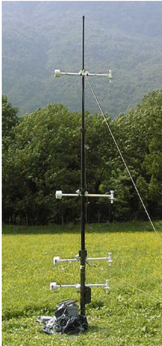
Abbildung 6: Temperatursensoren am Mast
