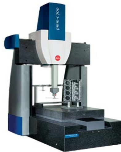
Abb.: Portal KMG (1 Hartsteinplatte; 2 Portal; 3 Pinole; 4 Längensystem; 5 Messkopf) 5
