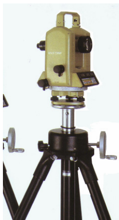
Abb.: T3000 (0,15 mgon) von Leica Geosystems (1992) und Totalstation TDA 5005 (2005)
