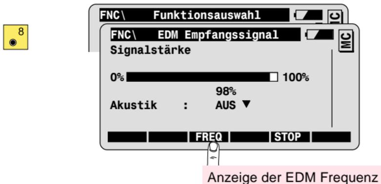
Die Stärke des reflektierenden Signals wird in Prozent angezeigt. Durch leichte Bewegung des Instruments in horizontaler und/oder vertikaler Richtung und gleichzeitiger Beobachtung der Signalstärke kann das Signalmaximum ermittelt werden. Dies kann v.a. bei weit entfernten Zielen unter schlechten Sichtverbindungen hilfreich sein.
