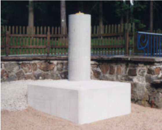
Abb. Beobachtungspfeiler und Zwangszentrierung
