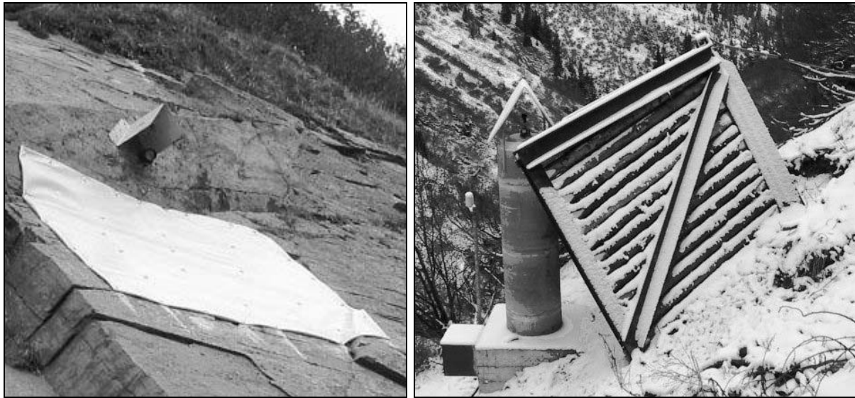
Abb 8 & 9: Prismenbefestigung an anstehendem Fels mit Schneerutschfolie oder auf doppelwandigem Pfeiler mit Lawinenschutzkeil
