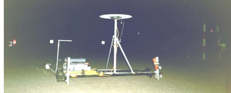
Gleismesswagen mit Trimble 4700-GPS
