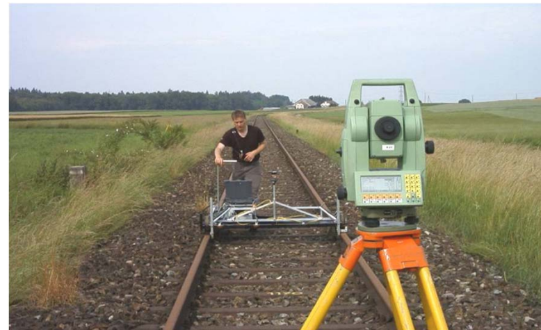
Tachymeter beim automatischen Verfolgen des Messwagens
