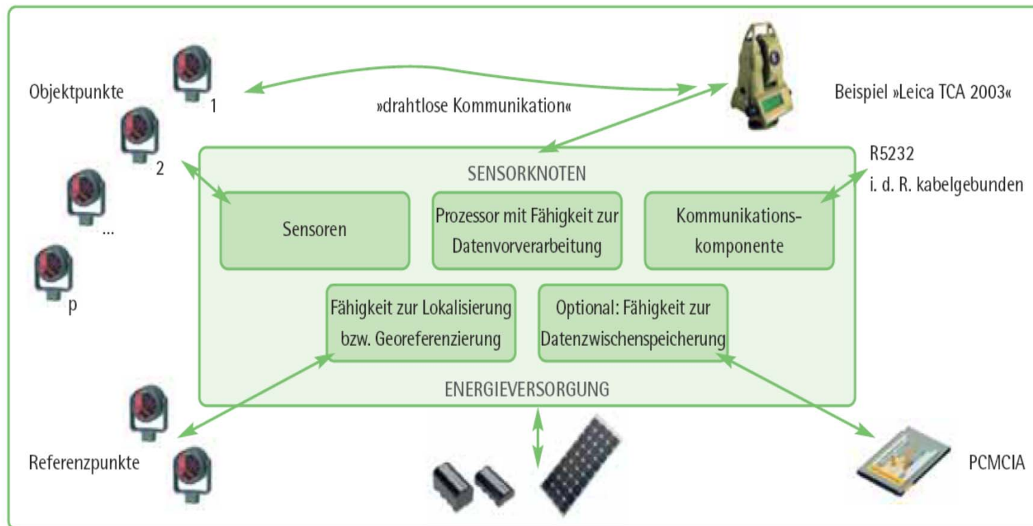
Abb. 3: Motorisiertes Tachymeter als Sensorknoten bei Überwachungsaufgaben
