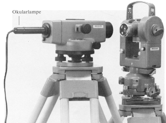
Bild 30 Automatisches Universal-Nivellier Wild NA2 mit Okularlampe als Kollimator zur Prüfung und Justierung anderer Nivelliere und Theodolite
