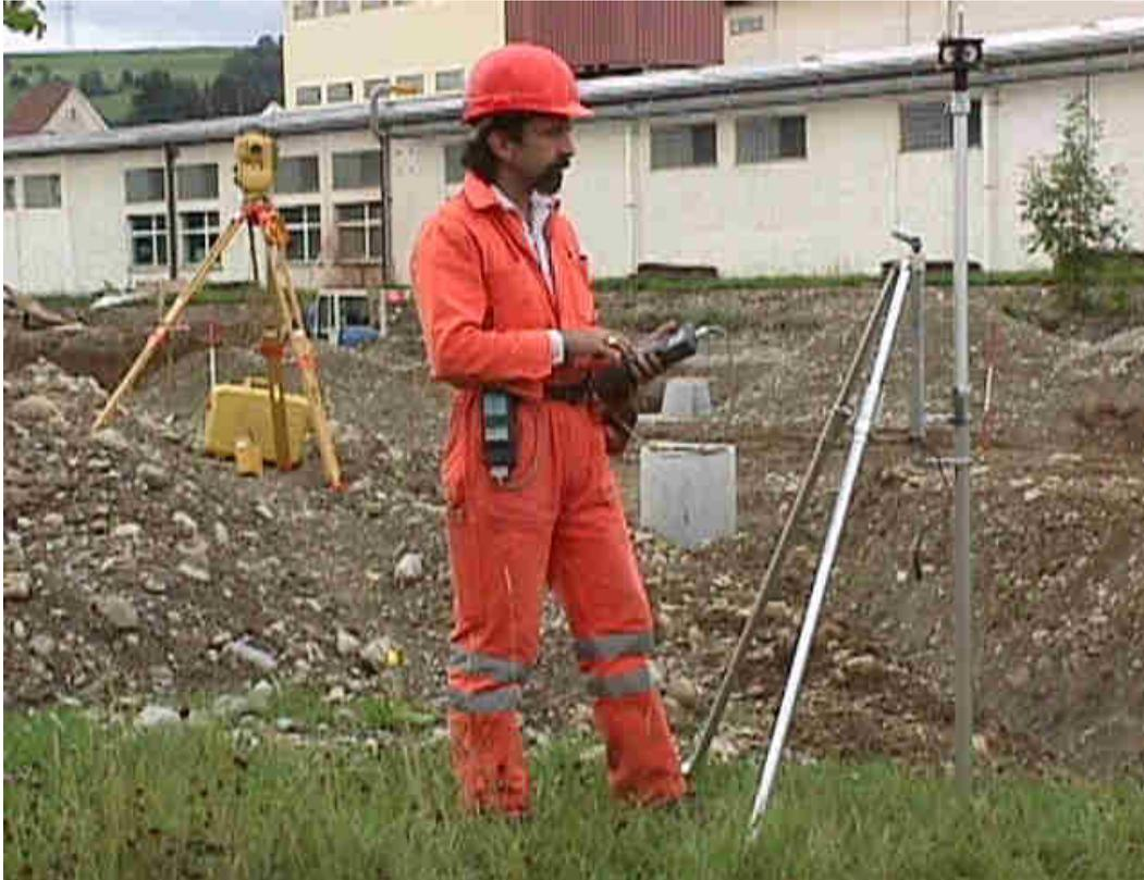
Der hier aufgeführte Ablauf entspricht dem polaren Verfahren, wie auch bei Verwendung eines GPS - Sensors
