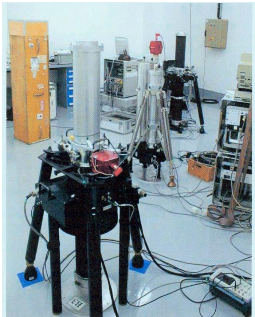
Abb. 6.17 Absolutgravimeter Typ FG5; Messprinzip: „freier Fall“
