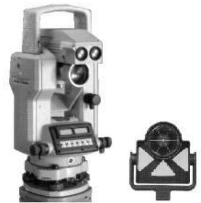
Abb. 3.75 T1000, Elektronischer Theodolit mit aufgesetztem Distanzmessgerät; rechts: Reflektor zu Theodolit mit aufgesetztem EDM: Zielmarke befindet sich unter dem Rundprisma;
