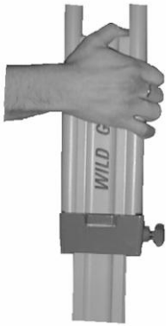
Abb. 3.27 Handgriff zur Sicherung des Stativs und zur Ausführung von Feinbewegungen der Stativbeine
