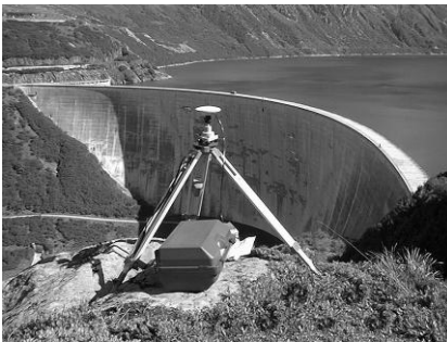
Abb. 1.5 Ingenieurgeodätische Beobachtungsmethoden bei der Überwachung einer Staumauer
