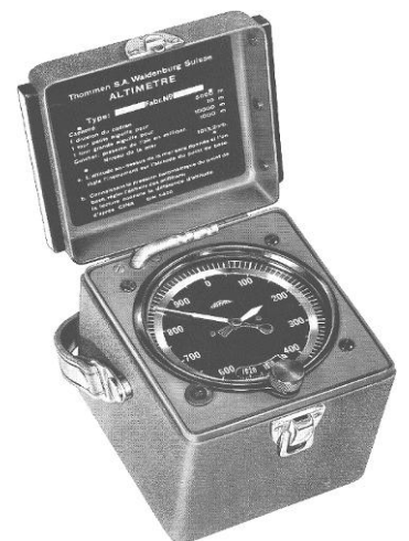
Abb. 6.12 Präzisionsaltimeter der Firma Thommen für Höhenmessungen
