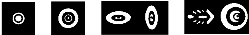
Abb. 7.19 Sternbilder von guten und fehlerhaften Objektiven, von links nach rechts (aus DEUMLICH [1980]):
