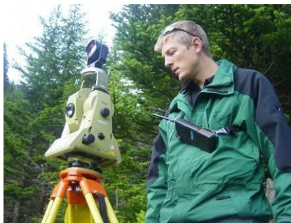
Abb. 6.37 Tachymeter vorbereitet für gegenseitig-gleichzeitige Beobachtung
